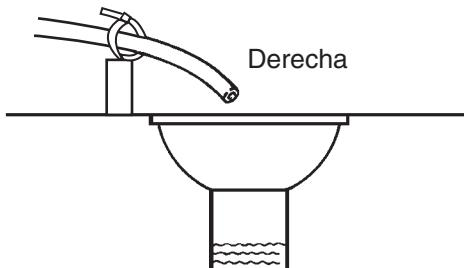
Figura 25 Conexión de la tubería de drenaje
