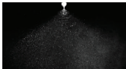
Patrón de pulverización flexible de 110° con inducción de aire que permite cumplir con las necesidades en muchas situaciones de pulverización.
