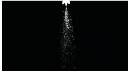
Diseño directo que estrecha el flujo del fluido para crear el patrón de pulverización frente al desvío del flujo y creación de una deriva de pulverización innecesaria.
