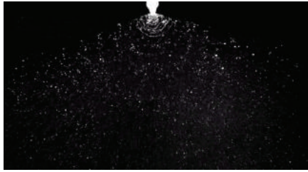
Patrón de pulverización amplio de 140° de gotas grandes para lograr la cobertura líder en la industria en aplicaciones de fertilizantes líquidos.
