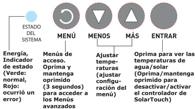
**Pantalla principal:** en modo de operación normal la pantalla principal muestra la temperatura del AGUA actual, la temperatura DESEADA y si las opciones CALOR SOLAR, ENFRIAMIENTO NOCTURNO o CONGELAMIENTO están ENCENDIDAS o APAGADAS. Oprima el botón Entrar para ver las temperaturas de agua y solar actuales. Si no se detecta actividad en el menú después de dos minutos, aparece la pantalla principal.
