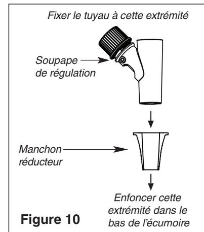
Toujours utiliser le régulateur d'aspiration avec le nettoyeur automatique de piscine. Le régulateur d'aspiration comporte un bouton de réglage. Si l'aspiration est trop forte, tourner le bouton dans le sens antihoraire afin de réduire l'aspiration. Si l'aspiration est trop faible, tourner le bouton dans le sens horaire afin d'augmenter l'aspiration.
