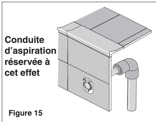
**⚠ WARNING** Risque d'aspiration, de blessures ou de noyade. Si la piscine est dotée d'un orifice d'aspiration pour passer l'aspirateur ou brancher le nettoyeur, cet orifice devra être bouché s'il n'est pas utilisé.
