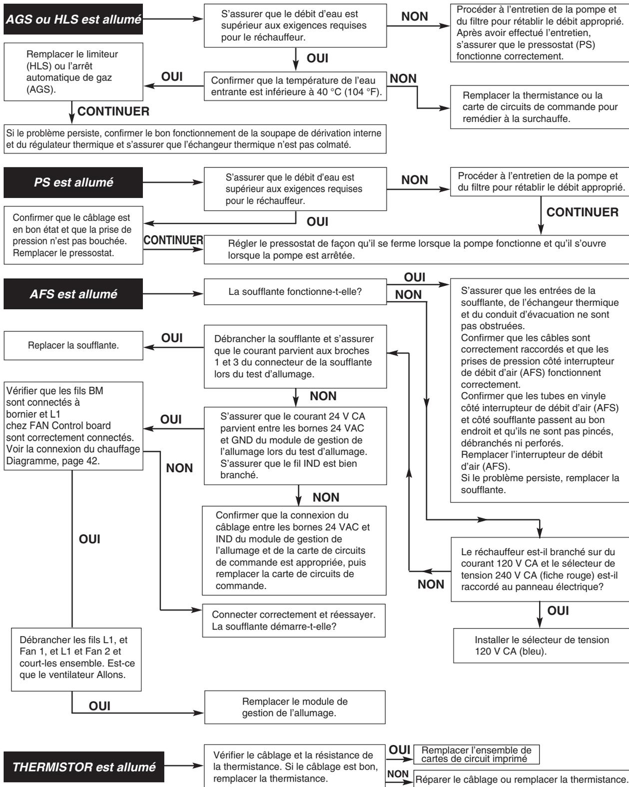
**MISE EN GARDE** Ne pas contourner un interrupteur de sécurité pour remédier à un interrupteur défectueux.
