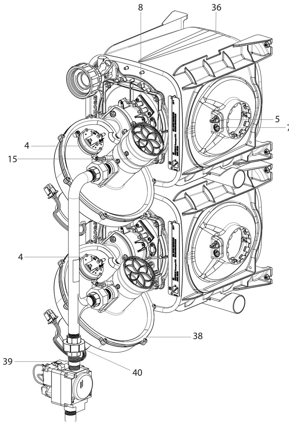
Ensembles d'échangeur thermique et de soufflante
