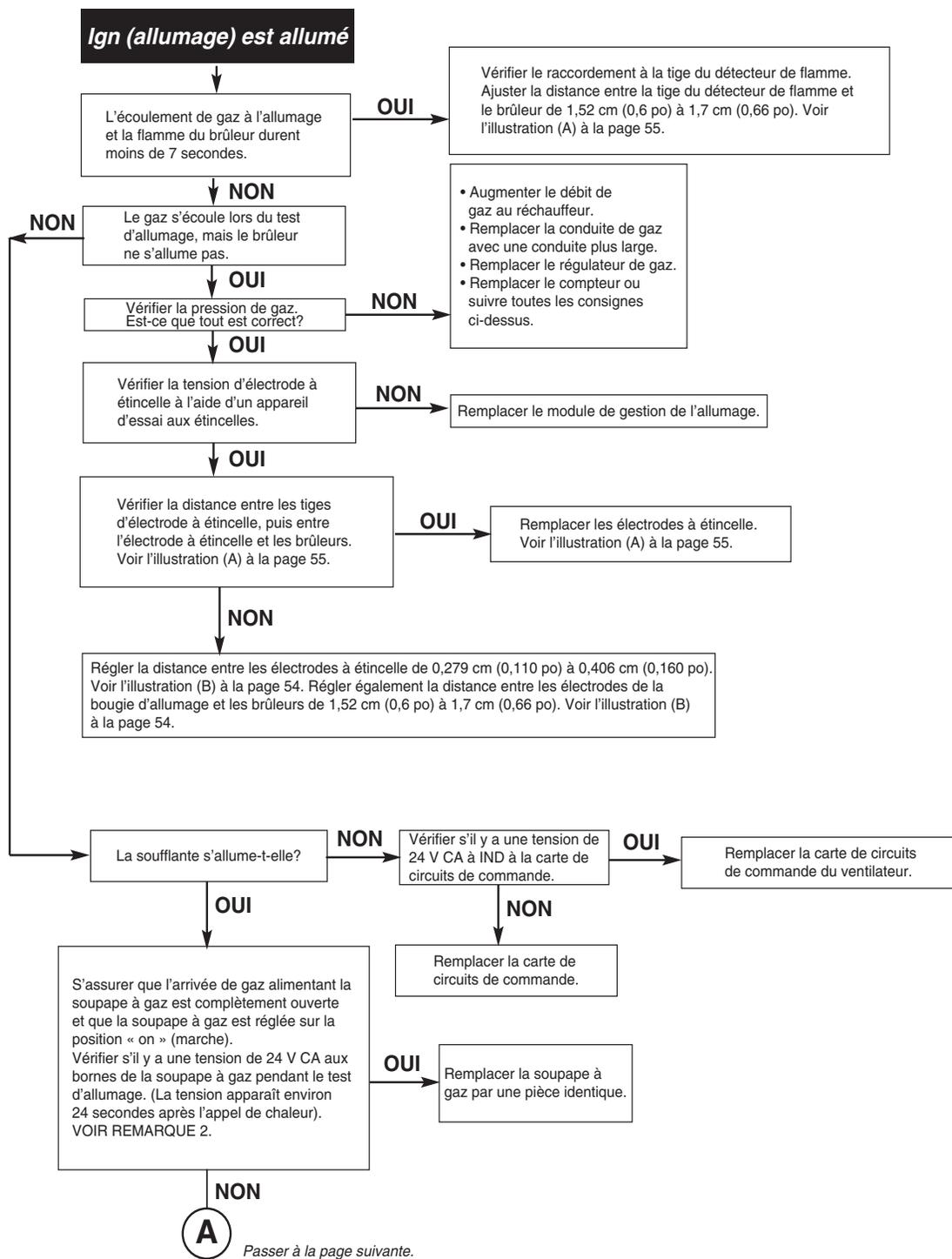
**Témoins DEL de diagnostic : PS (pressostat), HLS (limiteur), TF (fusible thermique), IGN (allumage), AFS (interrupteur du débit d'air), AG1 (arrêt automatique de gaz 1), AG2 (arrêt automatique de gaz 2), FS (interrupteur à flotteur) (suite...)**
