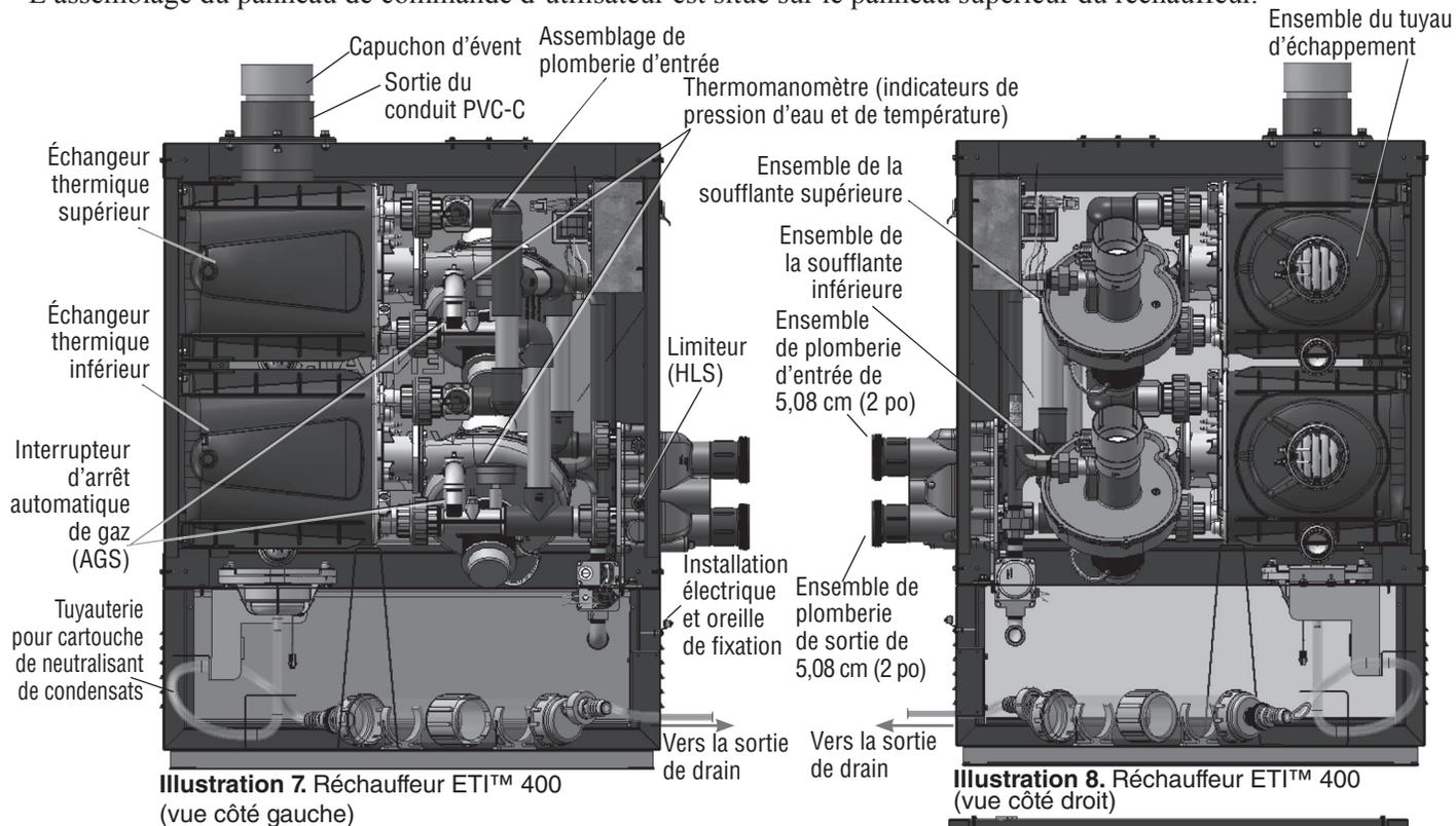
Cartouche du neutralisant de condensats (Optionnel, N/P 475612 vendu séparément). La cartouche peut être montée à la base du réchauffeur pour l'installation extérieure.
