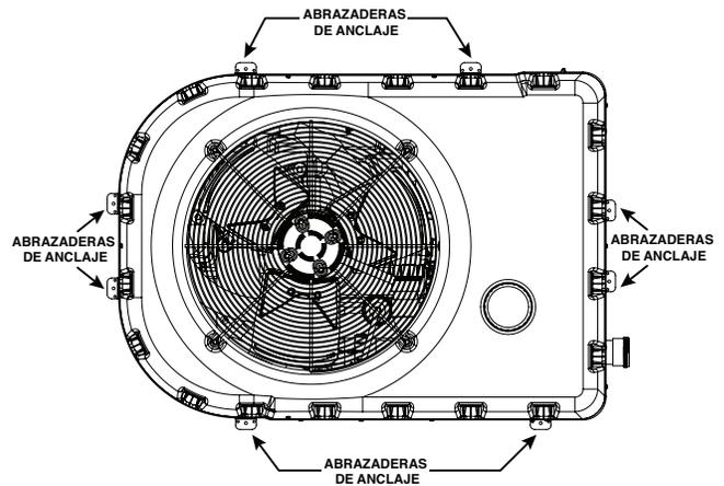
**Figura 5: Ubicaciones de las abrazaderas de anclaje**
