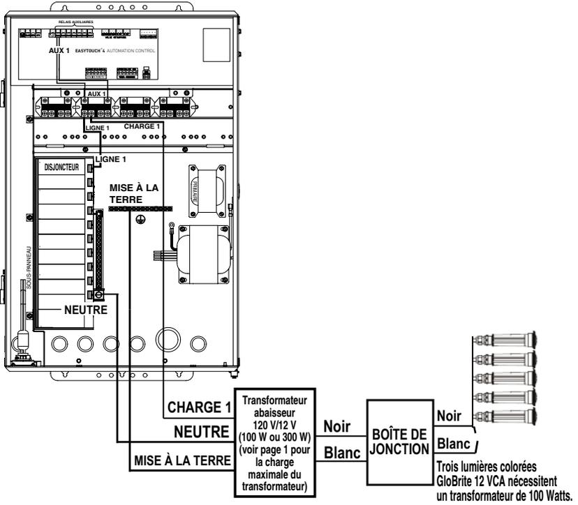
Schéma de câblage du centre d'alimentation des systèmes de contrôle EasyTouch® et IntelliTouch®
