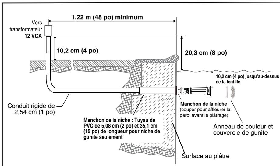
**Illustration 1 : Schéma d'installation de la lumière pour gunite**
