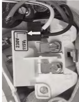
Figura 5A - Ficha de cambio de voltaje configurada para 230 Voltios.
