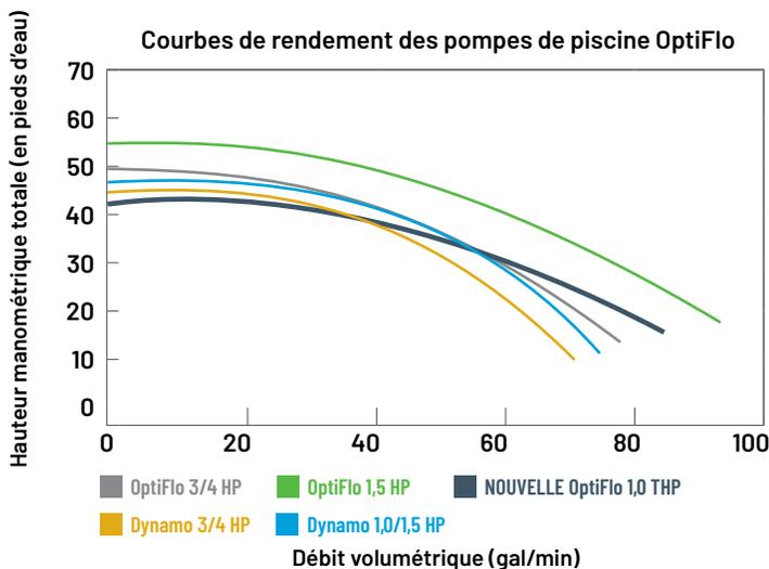
Remarque : Les pompes OptiFlo 3/4 HP, OptiFlo 1,5 HP et toutes les pompes Dynamo représentées ici sont des produits non conformes inclus strictement aux fins de comparaison. La nouvelle pompe OptiFlo 1,0 THP est la seule série de pompe pouvant être commandée.
