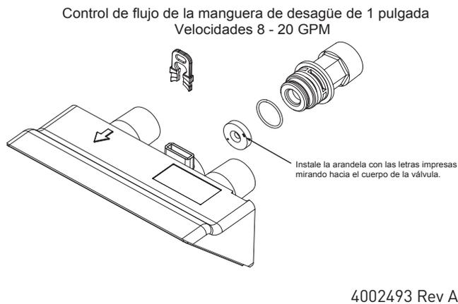
Figura 4 - Control de flujo de la manguera de desagüe de 1"
