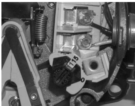
Figure 13 – Pour faire fonctionner le moteur sur le courant de 115 volts
