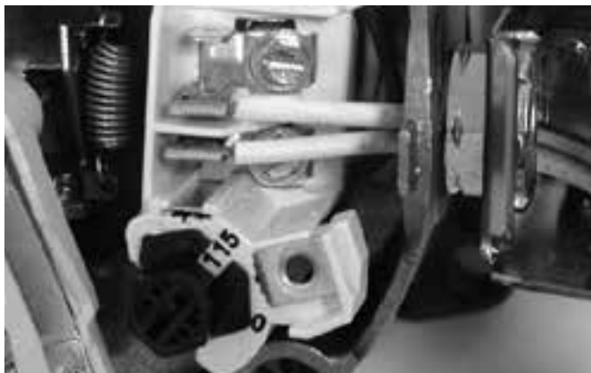
Figura 7: Tensión configurada para 115 voltios, tipo cuadrante.
