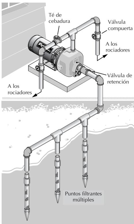
**Figura 2: Instalación en pozos hincados, pozos hincados múltiples**
