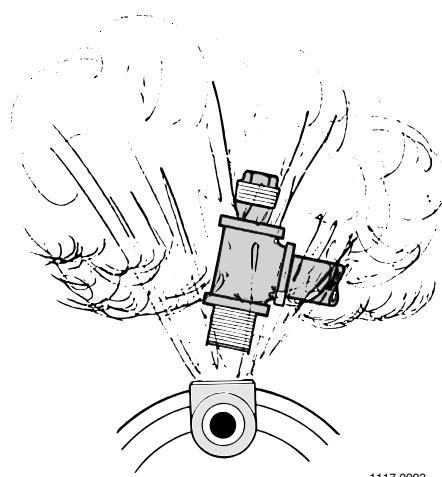
**Figura 5: No haga funcionar la bomba con la descarga cerrada**
