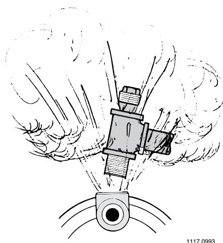
**Figure 5: Ne pas faire fonctionner la pompe avec l'ouverture de refoulement fermée.**
