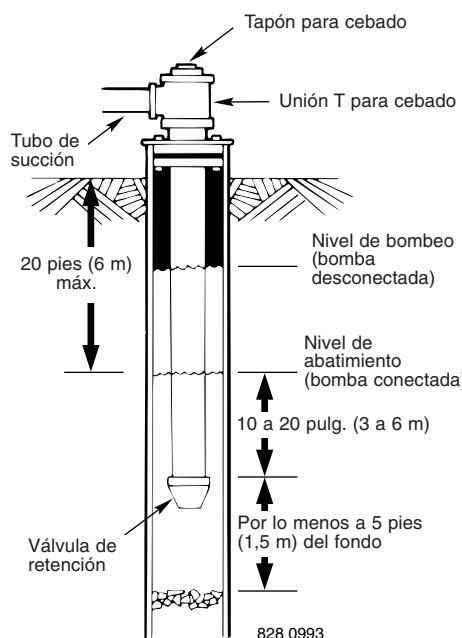
**Figura 1: Instalación en pozo revestido o excavado**
