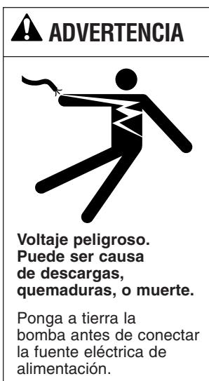
**⚠ Conecte el motor al voltaje correcto.** Véase la sección "Electricidad" del presente manual y los datos sobre la chapa del motor.
