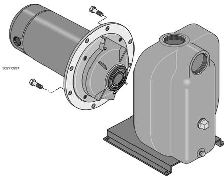
**Figura 17 - Deslice el motor hacia atrás**
