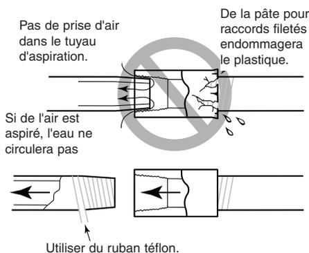
**Figure 4 - Le tuyau d'aspiration ne doit pas fuir**
