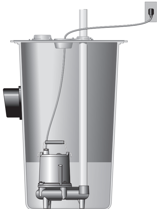
FIGURA 1 - SP40: INSTALACIÓN TÍPICA
