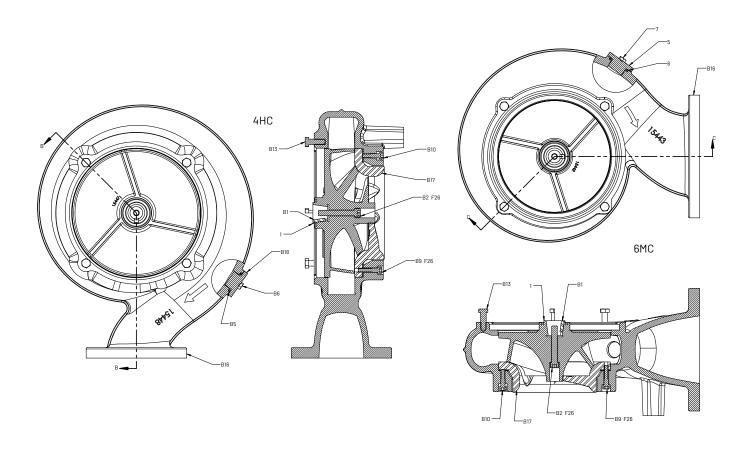
TYPICAL: GAP BETWEEN LINER(B17) AND IMPELLER(1) TO BE SET AT .008-.015" FROM FACTORY
