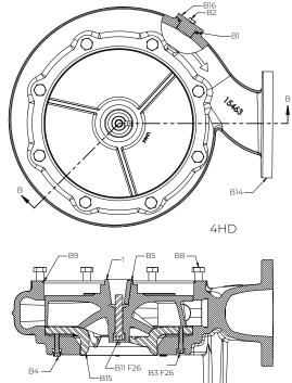
TYPICAL: GAP BETWEEN LINER(B15) AND IMPELLER(1) TO BE .008-.015" FROM FACTORY.
