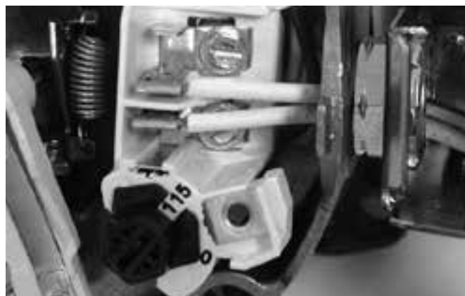
Figure 9 : Tension réglée sur le courant de 115 volts. Sélecteur à cadran rotatif
