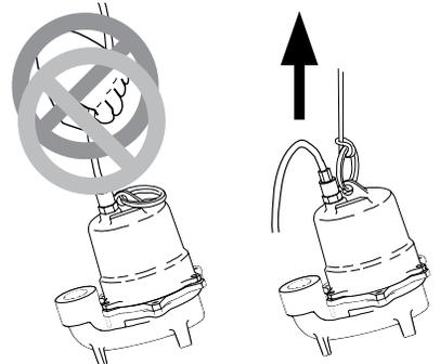
1. Essayer de lever ou de supporter la pompe par son cordon électrique risque d'endommager le cordon électrique et les connexions du cordon électrique.
