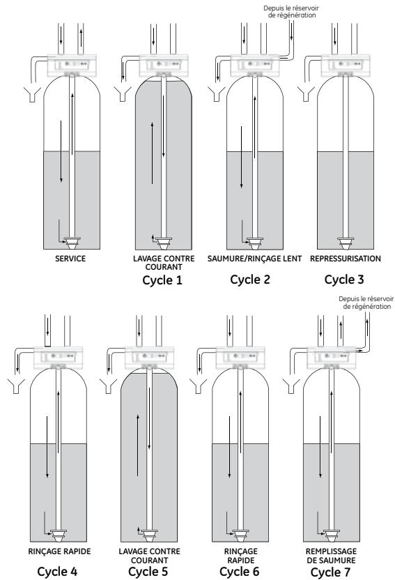
Figure 1 Modèles d'écoulement
