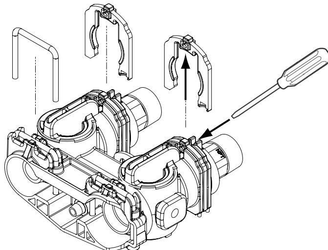
Figura 26 Instalación del conector
