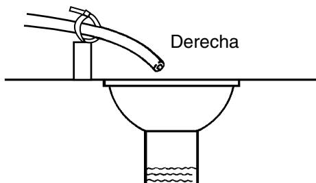
Figura 27 Conexión de la tubería de drenaje
