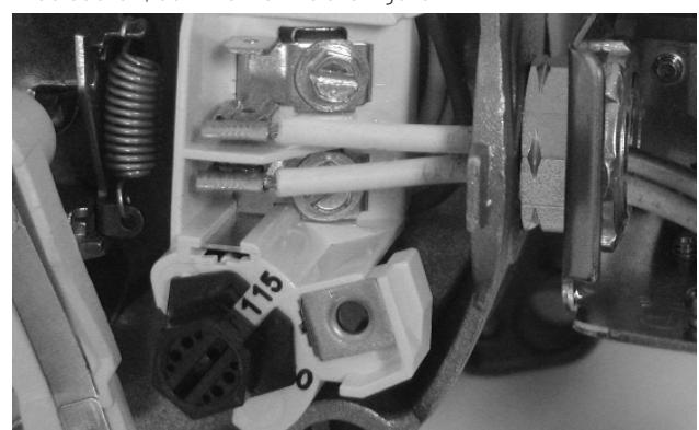
Figure 17 : Tension réglée à 115 V, type de cadran
