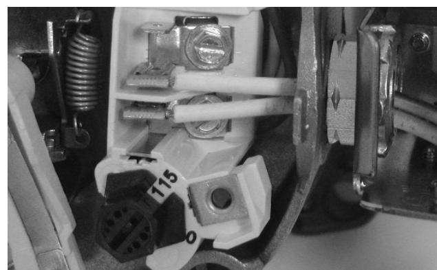
Figura 17 - Voltaje configurado a 115 V, tipo dial
