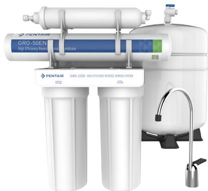
Le système Pentair GRO-2550 comporte une membrane encapsulée GRO-50 à haut taux de récupération. Le système comprend un préfiltre de 5 microns pour sédiments et un préfiltre au charbon qui réduisent les sédiments et les odeurs et améliorent le goût.
