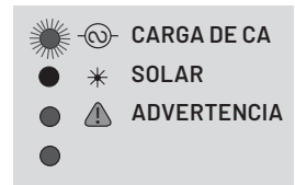
Figura 18: LED 1 - CARGA DE CA está ENCENDIDA
