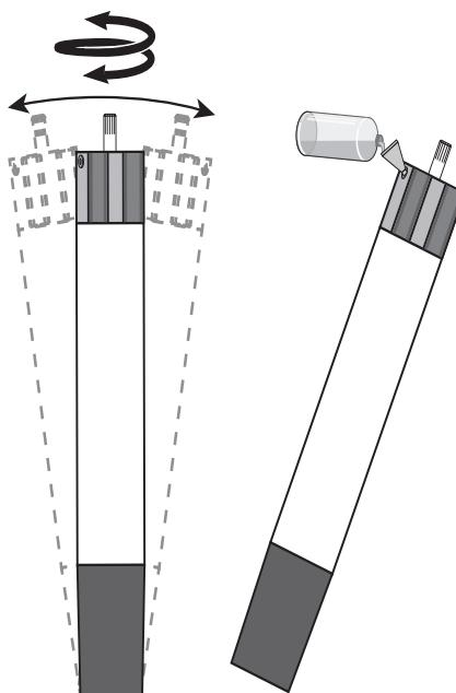
B. Llenar el motor; volver a balancear y llenar hasta que el motor esté lleno
