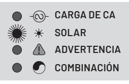
Figura 19: LED 2: la carga solar está encendida
