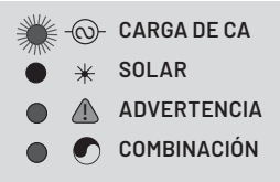
Figura 18: LED 1: la carga de CA está encendida
