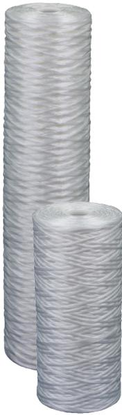
Los Cartuchos Serie WPX-BB Pentair Pentek® están fabricados en longitudes de 10" y 20" y en diámetros de 4,5" desde una cadena de polipropileno duradero que se enrolla alrededor de un núcleo de polipropileno rígido. Los Cartuchos WPX-BB son una solución económica para reducir el sedimento fino incluido polvo, arena y partículas de escala.
