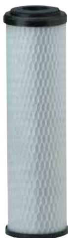
La cartouche de la série C8 Pentair® Pentek® constitue une solution économique pour des besoins en matière de filtration générale de l'eau. Faite d'un matériau en cellulose imprégné de carbone, cette cartouche à double usage filtre le goût et l'odeur de chlore, les mauvais goûts et les mauvaises odeurs ainsi que les particules de sédiments\*. La cartouche a une capacité de rétention des impuretés élevée et peut être utilisée dans une grande variété d'applications.
