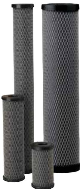
Les cartouches de la série C Pentair® Pentek® constituent une solution économique pour tous vos besoins en matière de filtration générale de l'eau. Fait d'un matériau en cellulose imprégné de carbone, ces cartouches à double usage filtrent les particules de sédiments et réduisent les goûts et les odeurs indésirables ainsi que le goût et l'odeur de chlore de l'eau de votre robinet\*. Le filet externe assure une solidité et une capacité de rétention des impuretés supplémentaires.
