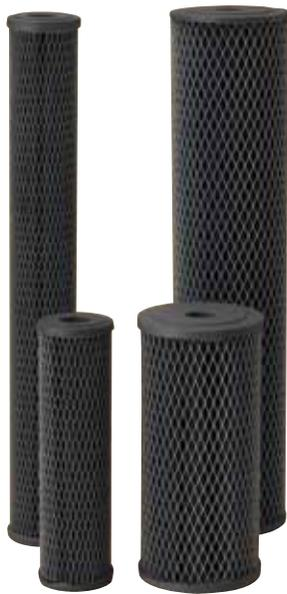
Les cartouches de la série NCP Pentair® Pentek® sont faites à partir d'un matériau non cellulosique imprégné de carbone. Elles assurent une filtration des sédiments ainsi qu'une réduction des goûts et des odeurs, du goût et de l'odeur de chlore, le tout dans une seule cartouche. À la différence des cartouches en cellulose, les cartouches de la série NCP peuvent être utilisées pour des applications impliquant l'eau municipale et de l'eau non chlorée.
