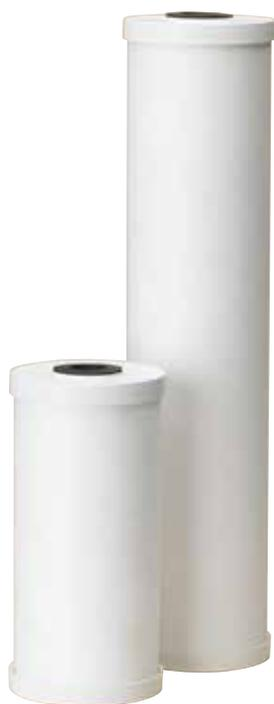
Les cartouches de la série RFC Pentair® Pentek® sont faites avec une coque extérieure en polyéthylène poreux de 70 micromètres et des embouts en polypropylène durable. Les cartouches de diamètres extérieurs de 2 3/4 po ont un noyau en polypropylène et les cartouches de diamètres extérieurs de 4 1/2 po intègrent un noyau en polypropylène tissé. Un lit de charbon actif granulaire (GAC) est pris en sandwich entre la coque extérieure et le noyau.
