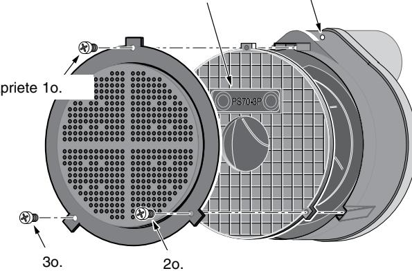
Ensamble la pantalla y el casco según se ilustra.
