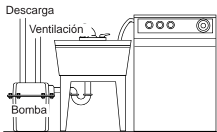
Figura 9 – Instalación típica en lavaderos y lavarropas
