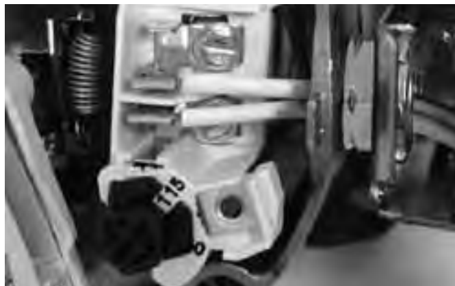
Figura 5: Tensión configurada para 115 V, tipo cuadrante.
