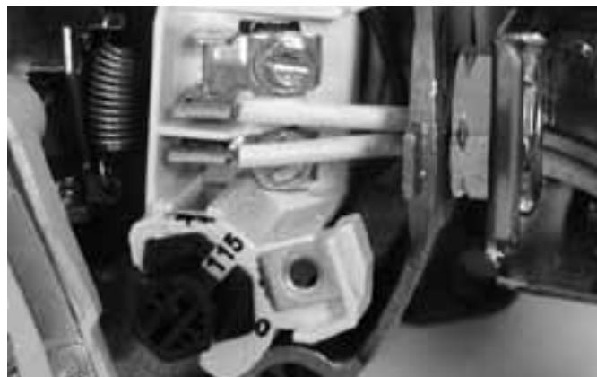
**Figura 7: Tensión configurada para 115 voltios, tipo cuadrante.**
