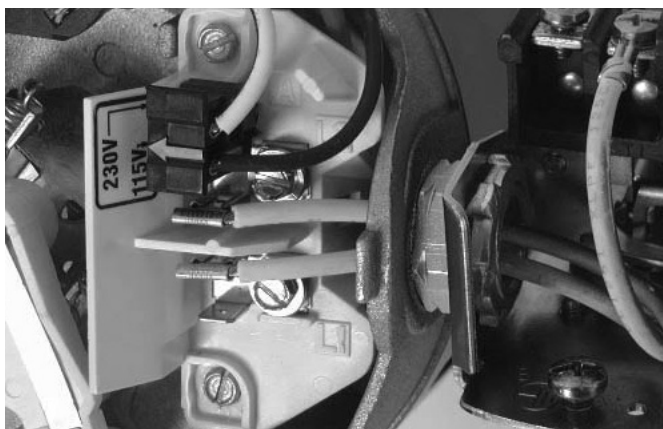
Figura 7: Tensión configurada para 115 V, tipo ficha.
