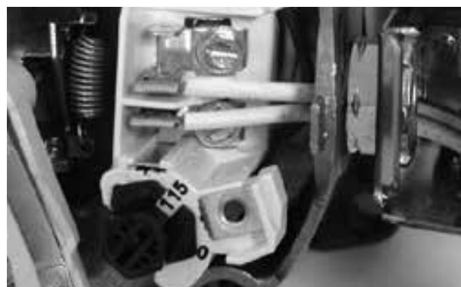
Figura 8:Tensión configurada para 115 V, tipo cuadrante.
