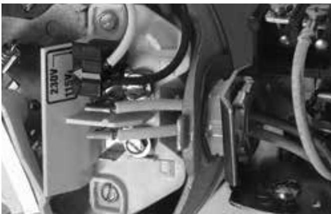
**Figura 6:Tensión configurada para 115 V, tipo ficha.**
