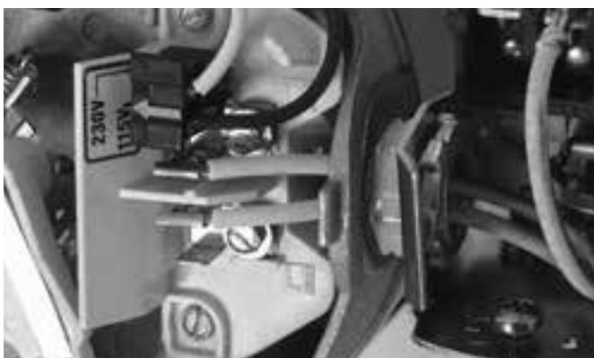
Figura 6:Tensión configurada para 115 V, tipo ficha.
